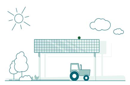
Mit "Agri-Photovoltaik"-Anlagen lässt sich die Erzeugung von Solarstrom und die Bewirtschaftung von Acker- oder Grünland mit herkömmlichen Landmaschinen ideal kombinieren. Denn auf den Flächen unter bzw. zwischen den Solarmodulen können weiterhin Nutzpflanzen angebaut werden.
